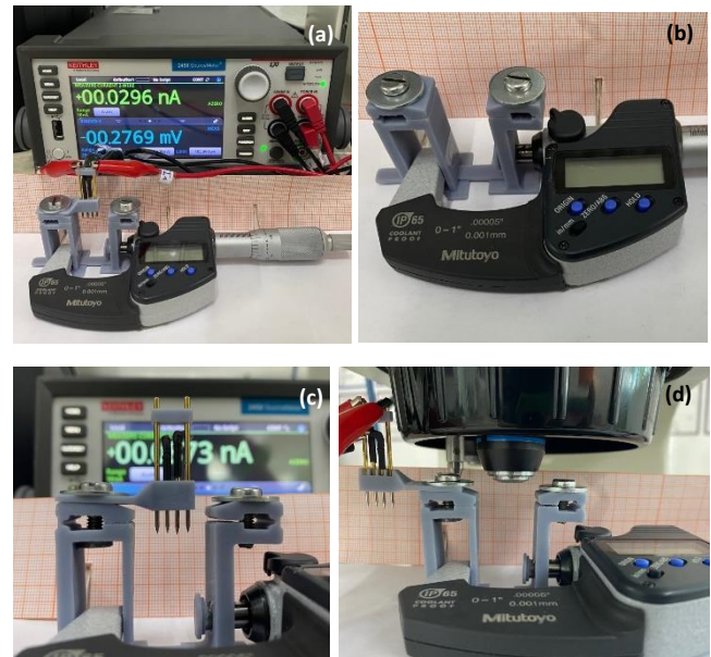
Fig. 4. Elementos de la prueba de tensión uniaxial horizontal. (a) Montaje experimental; (b) Sujeciones y sistema motriz; (c) 4 Puntas colineales; (d) Montaje en microscopio.
